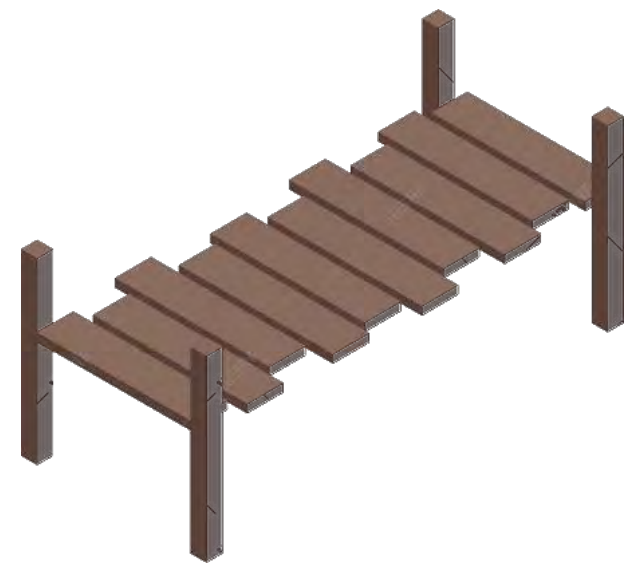
Passerelle bois au dessus de la noue
